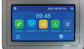
Ovládání hydroboxů a jednotek ALL IN ONE je řešeno pomocí vestavěných dotykových ovladačů. Ovladač umožňuje ekvitermní regulaci, týdenní program, regulaci dle referenční místonosti a další možnosti. Zaručujeme Vám příjemný tepelný komfort po celý rok.
